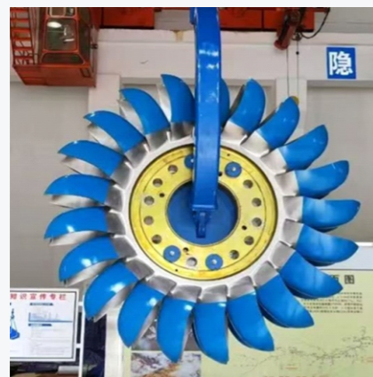
国内首台150兆瓦级冲击式机组转轮—国家能源局2023年度能源行业十大科技创新成果
