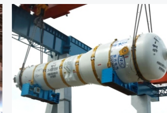
“华龙一号”ZH-65型蒸汽发生器
