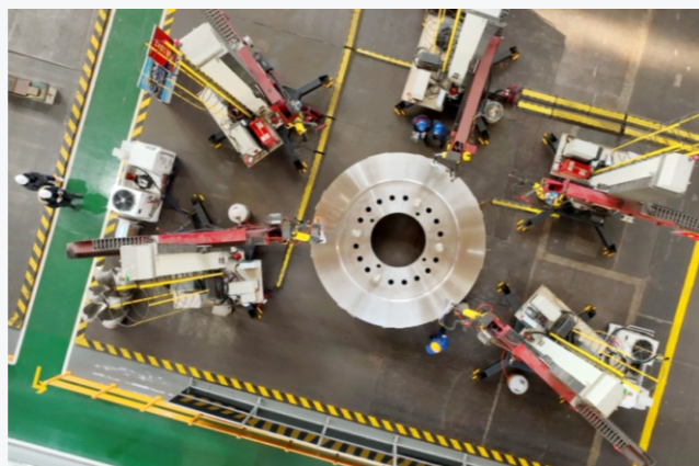
世界首台单机容量500兆瓦冲击式水电机组转轮中心体锻件
